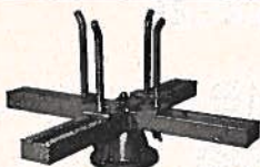
afwikkellapparaat A 61 820 mm ø, 300 kg
